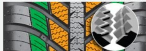
3D-Lamellen – Erhöhte Blockstabilität
