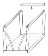
6. Alle mittige Stämme festschrauben. GANZ WICHTIG: Wenn alle Stämme festgeschraubt sind, dann alle Stämme zusätzlich mit den Nägeln befestigen (2-3 Nägel pro einen Stamm, die Schrauben allein halten nicht, weil das Holz immer arbeitet und die Schrauben zerbrechen können. Am besten für die Nägel die Löcher bohren.
