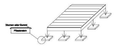
2. Die Baustämme genau auf den markierten Stellen setzen und fest schrauben. Danach die Stämme mit Nägeln verfestigen.
