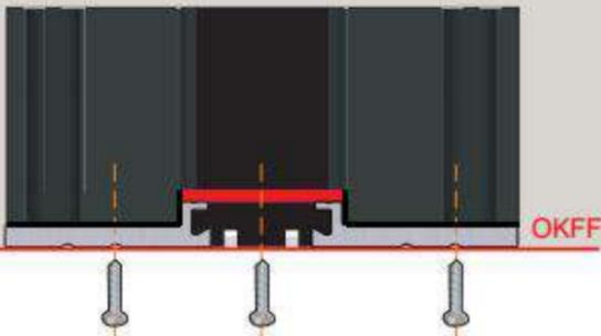
Bodenstatikprofil in EV1 mit der Positionierungsnut und dem Abdichtungsband Serienmäßig. Unten mit einem optimalen Querschnitt garantiert eine absolut formstabile Konstruktion unserer Türen, die sehr wichtig für den Transport und eine schnelle und genaue Montage ist.
